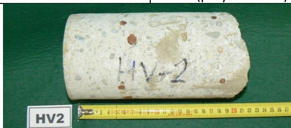
Obr. 8.7 Vzorek HV2 o průměru 100 mm a celkové délce přibližně 200 mm
