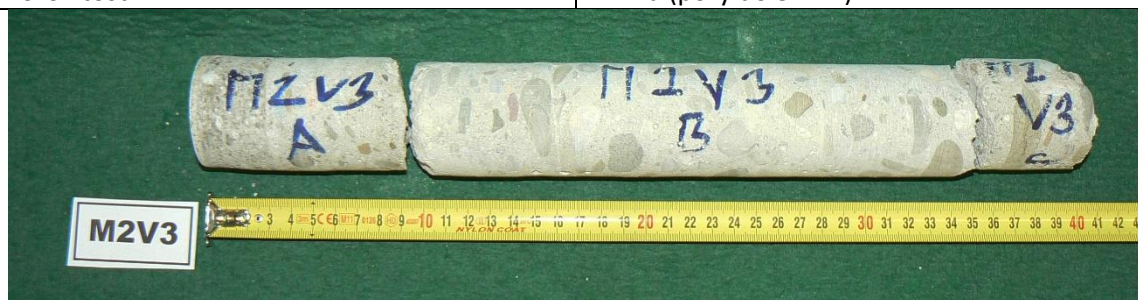
Obr. 8.17 Vzorek M2V3 o průměru 50 mm a celkové délce přibližně 400 mm
