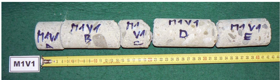
Obr. 4.13 Vzorek M1V1 o průměru 50 mm a celkové délce přibližně 420 mm
