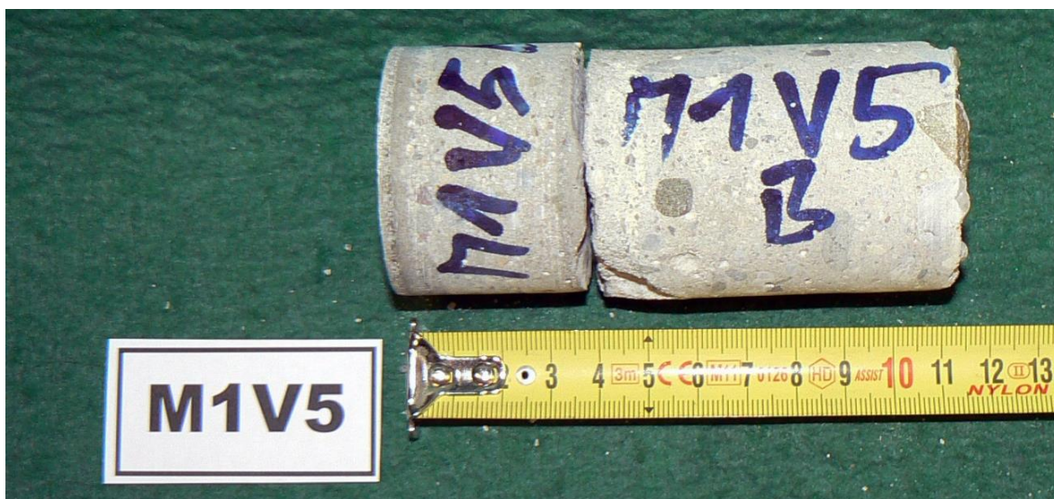
Obr. 4.17 Vzorek M1V5 o průměru 50 mm a celkové délce přibližně 115 mm
