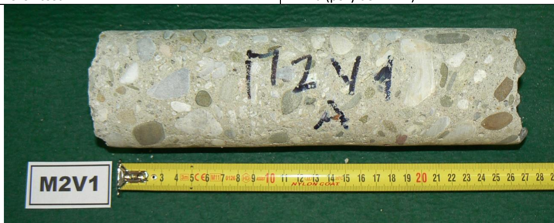
Obr. 8.13 Vzorek M2V1 o průměru 75 mm a celkové délce přibližně 260 mm
