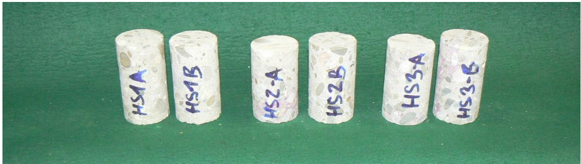
Obr. 4.20 Fotodokumentace zkušebních těles ze sloupů v hale
