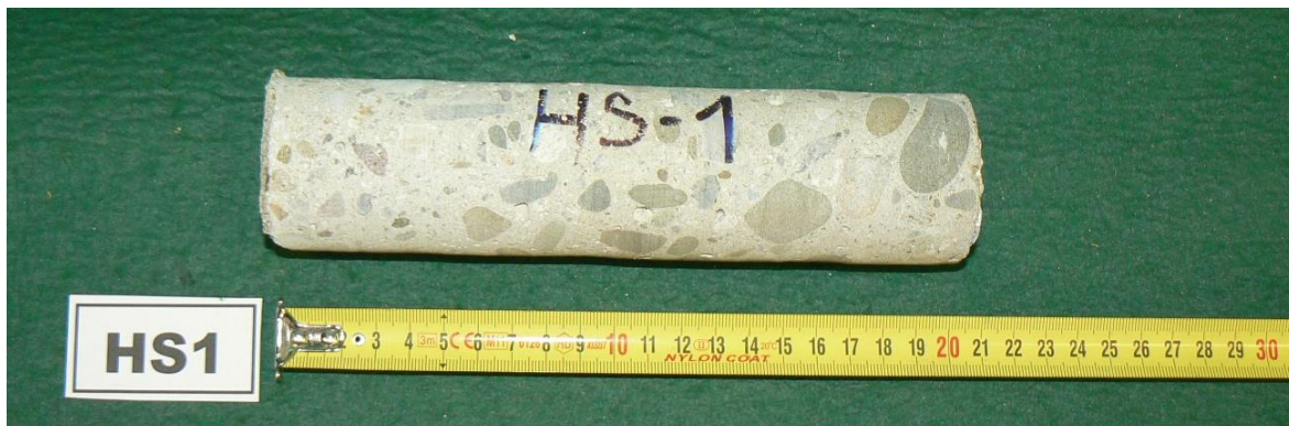
Obr. 4.8 Vzorek HS1 o průměru 50 mm a celkové délce přibližně 200 mm
