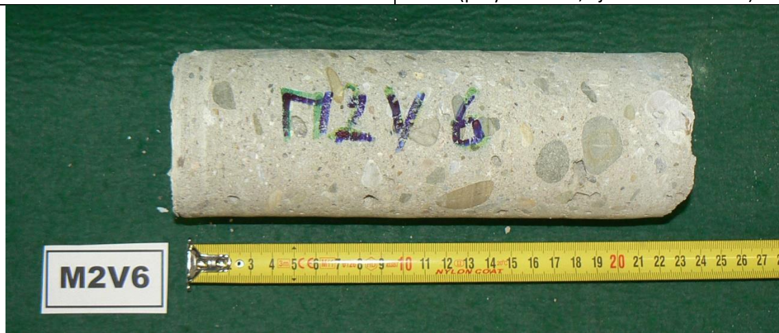
Obr. 8.23 Vzorek M2V6 o průměru 75 mm a celkové délce přibližně 220 mm
