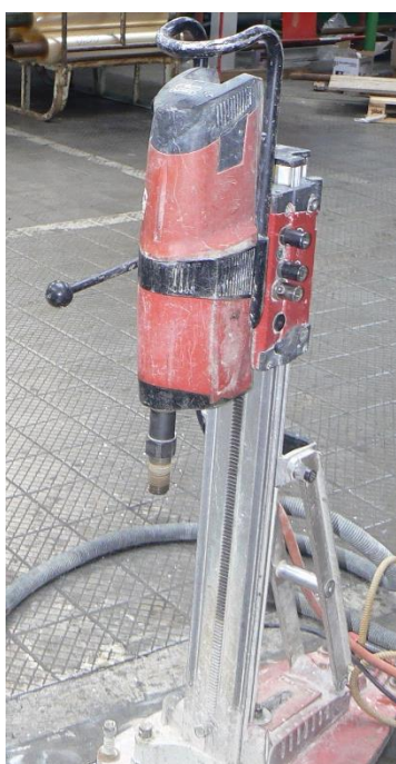
Obr. 3.3 Jádrová vrtačka a jádrový vývrt
