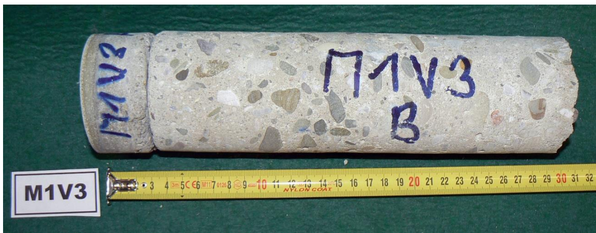
Obr. 4.15 Vzorek M1V3 o průměru 75 mm a celkové délce přibližně 290 mm
