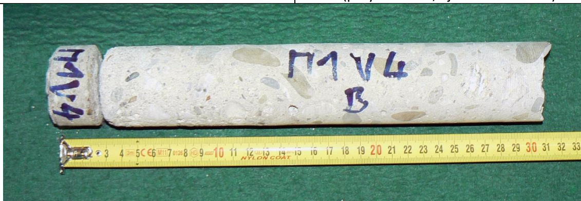
Obr. 8.11 Vzorek M1V4 o průměru 50 mm a celkové délce přibližně 300 mm
