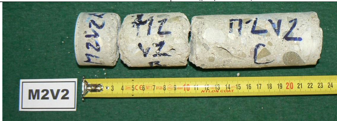
Obr. 8.15 Vzorek M2V2 o průměru 50 mm a celkové délce přibližně 225 mm
