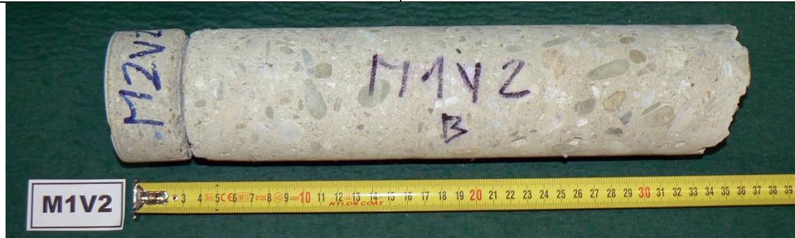
Obr. 8.9 Vzorek M1V2 o průměru 75 mm a celkové délce přibližně 350 mm
