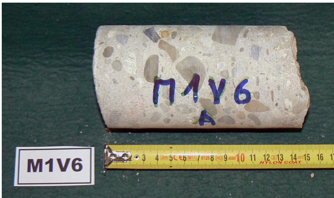
Obr. 4.19 Vzorek M1V6 o průměru 75 mm a celkové délce přibližně 145 mm
