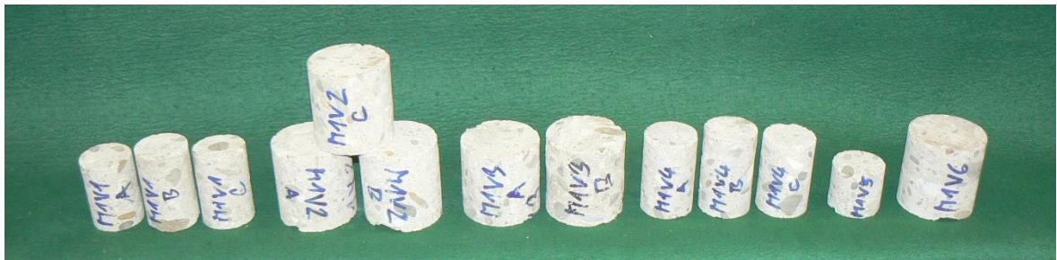
Obr. 4.22 Fotodokumentace zkušebních těles stropní konstrukce nad 1. NP a sloupů 1. NP třípodlažní budovy
