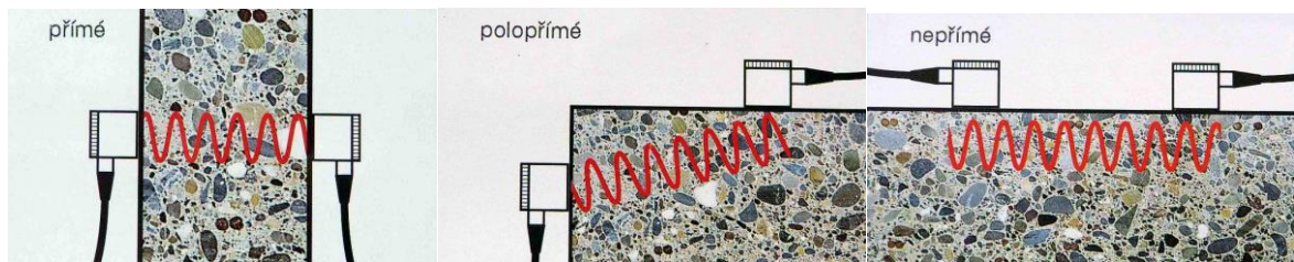
Obr. 3.5 Způsoby prozvučování pomocí dvou sond [3]
