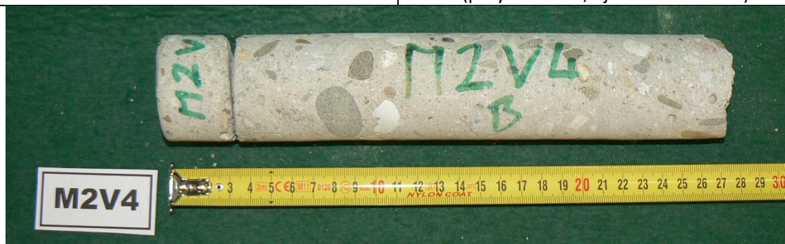
Obr. 8.19 Vzorek M2V4 o průměru 50 mm a celkové délce přibližně 270 mm
