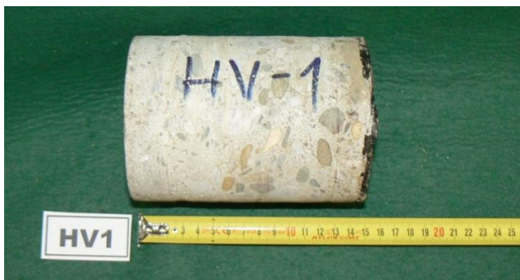
Obr. 4.11 Vzorek HV1 o průměru 100 mm a celkové délce přibližně 140 mm
