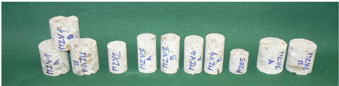
Obr. 4.23 Fotodokumentace zkušebních těles stropní konstrukce nad 2. NP a sloupů 2. NP třípodlažní budovy
