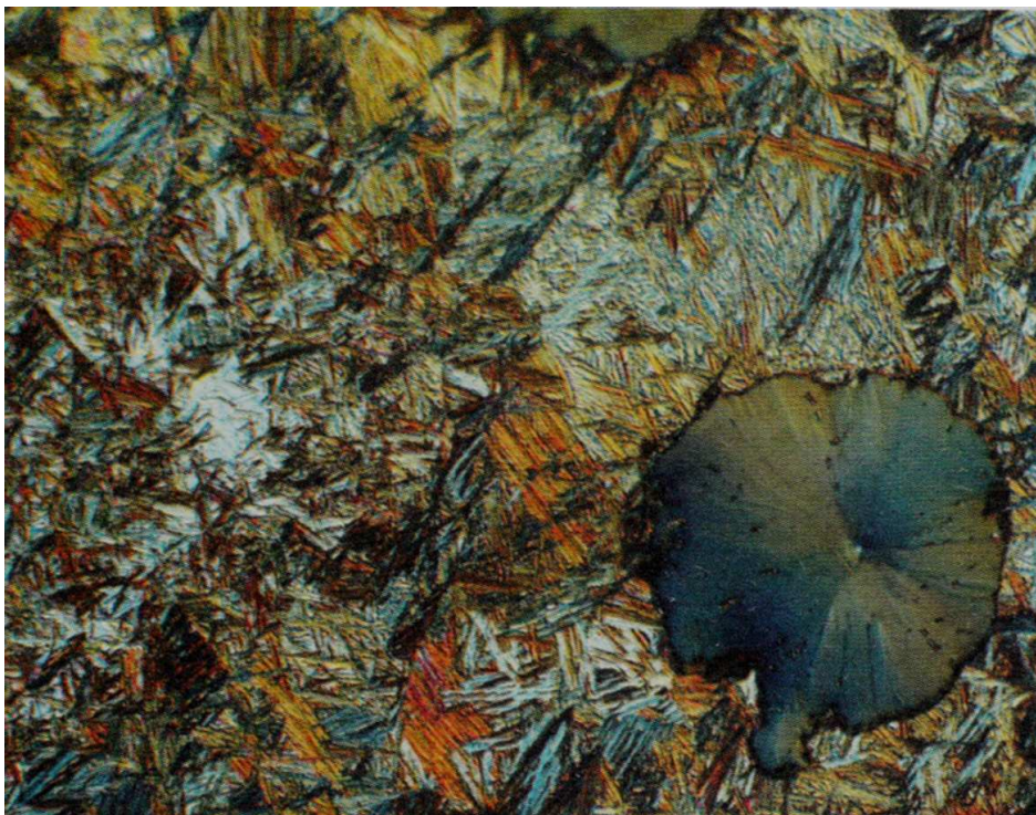
Obr.26 ADI – struktura dolního bainitu BD15
