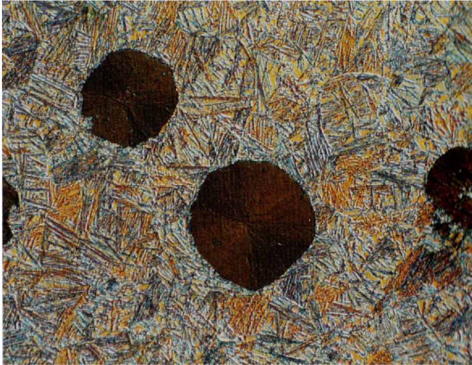
Obr.25 ADI – struktura přechodového bainitu BP15
