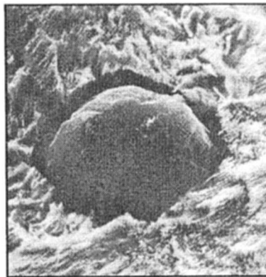
Obr.8 Kulička grafitu ve struktuře litiny REM, 2000x
