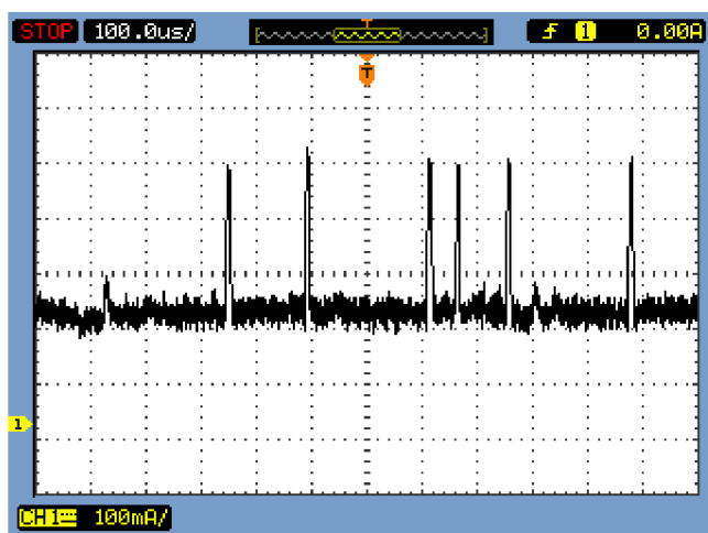
Obr. 5-3 Průběh signalu na sběrnici. Panel byl v tuto chvíli bez jakékoli zátěže. Informace se na sběrnici zřejmě vyskytují neustále
