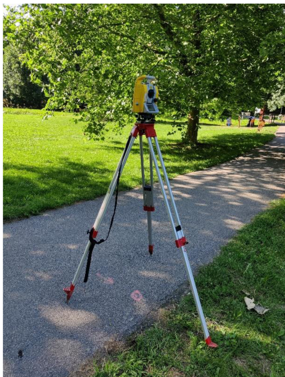
Obrázek 3.3: Zcentrovaná a zhorizontovaná totální stanice Trimble M3 (vlastní)
