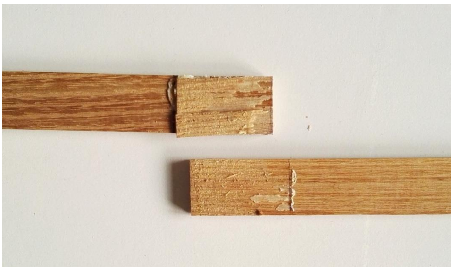
Obr. 15 Porušení spoje ve dřevě u akátu.
