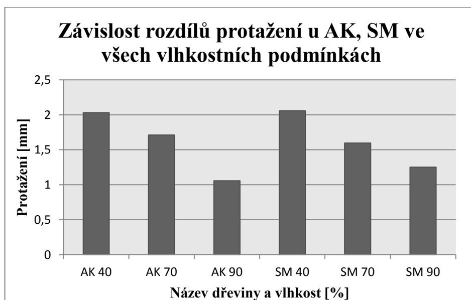
Obr. 20 Závislost protažení u SM, AK pro vlhkostní podmínky 40 %, 70 %, 90 %.
