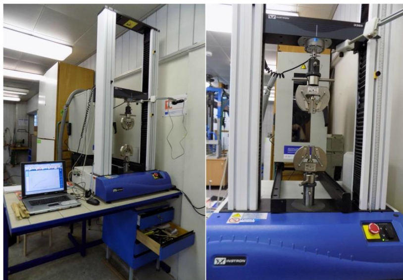
Obr. 9 Trhací stroj s připojeným počítačem. 55
