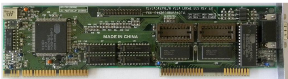
Obrázek 6 Grafická karta od firmy Cirrus Logic se sběrnice VESA Local Bus, 1MB, 32bit, 80MHz, rok výroby 1993 [11]
