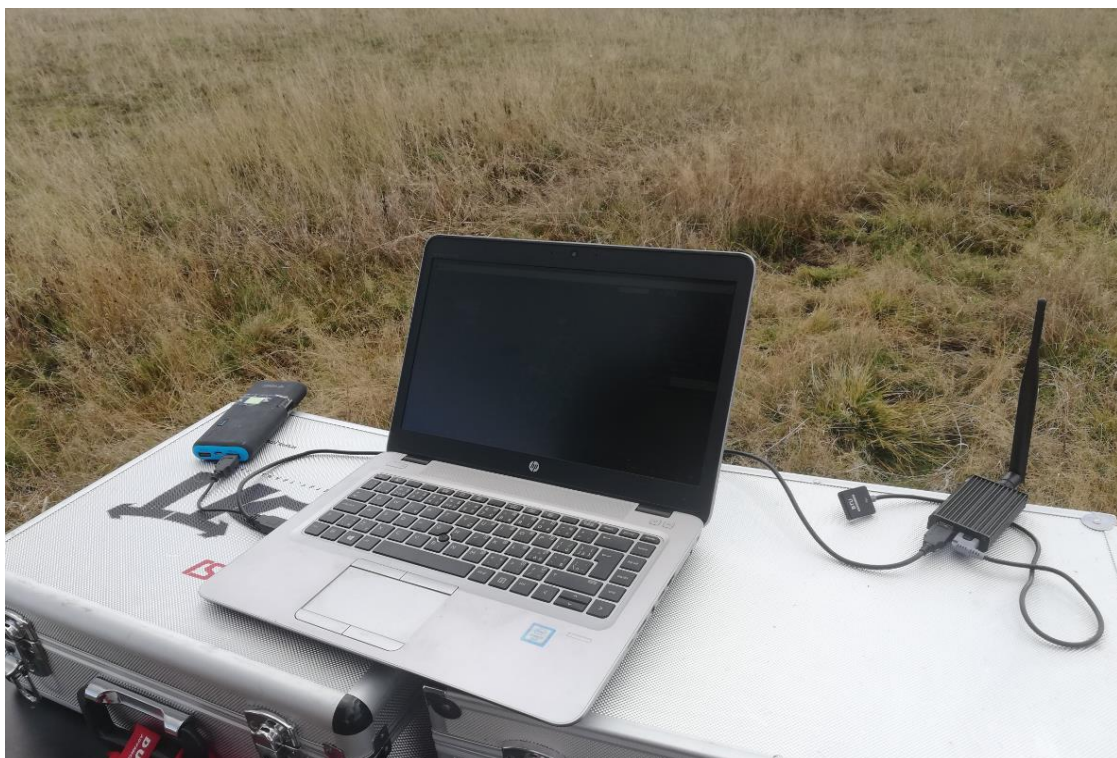
Obrázek 8: Pozemní řídicí stanice (Foto Autor)
