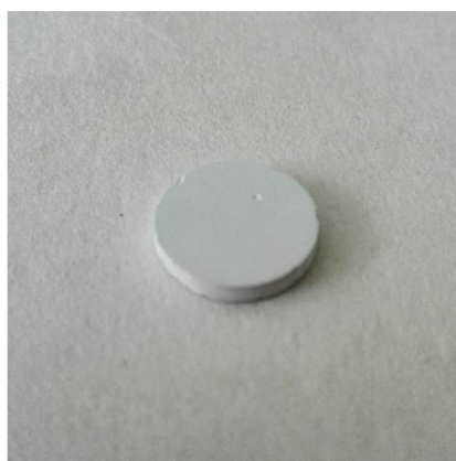
Obrázok 13: Pripravená a vypálená HAp tableta
