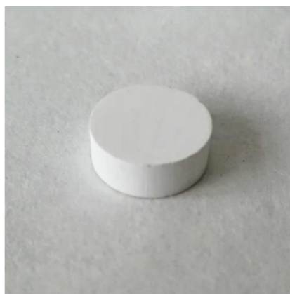
Obrázok 11: Pripravená a vypálená Al 2 O 3 tableta
