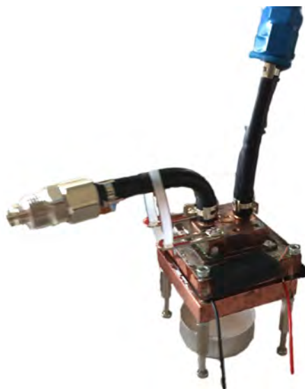
Obrázek 9.6: Termoelektrický generátor po montáži
