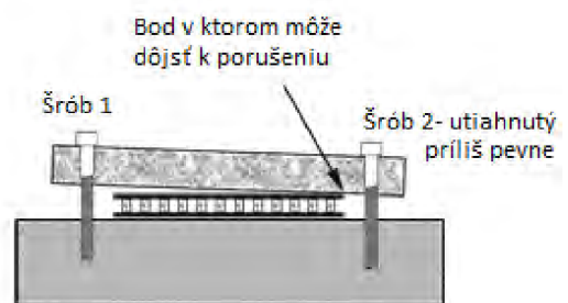
Obrázek 9.5: Nebezpečie poškodenia pri utáhovaní [6]
