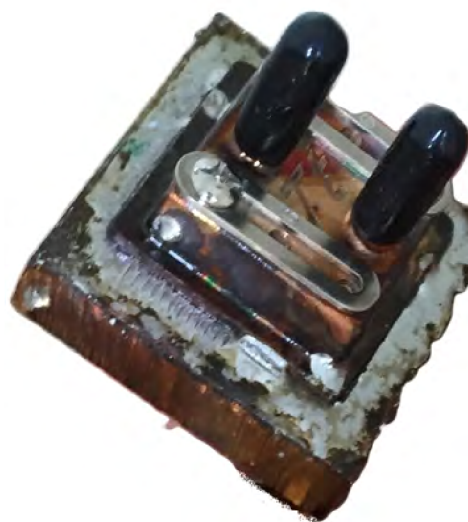
Obrázek 9.2: Chladič spájaný s medeným kvádrom
