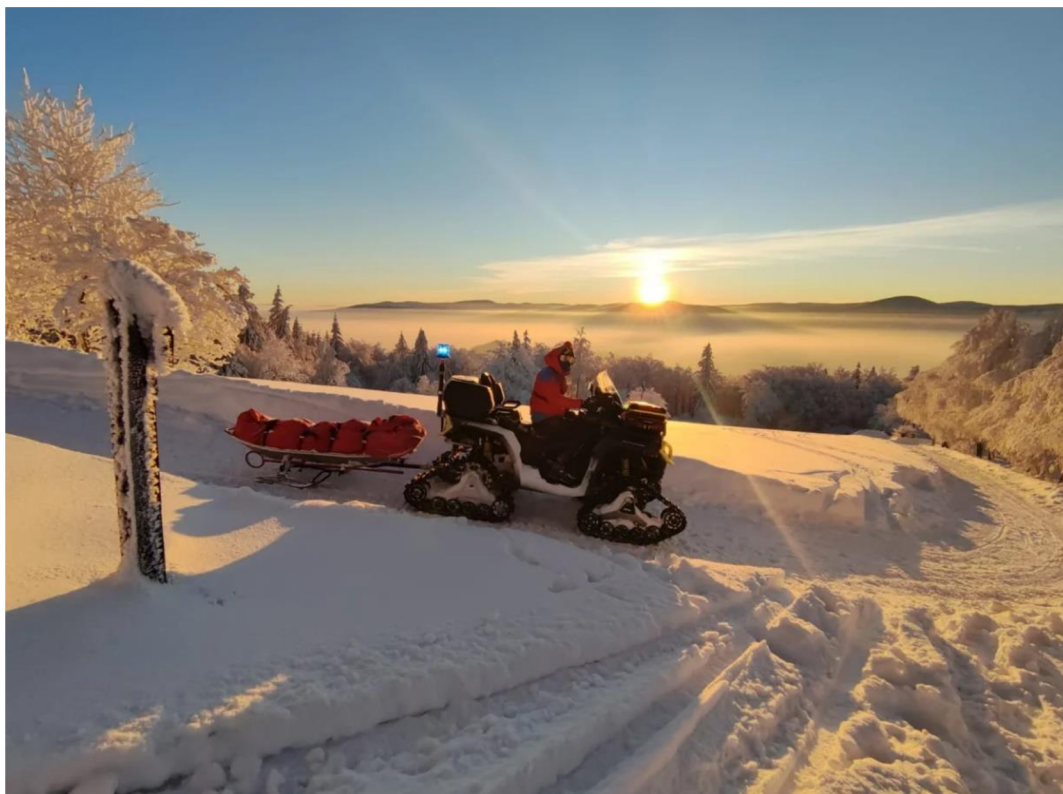
Obrázek č. 5 Čtyřkola vybavena pásovým „kitem“ pro jízdu ve sněhu 34
