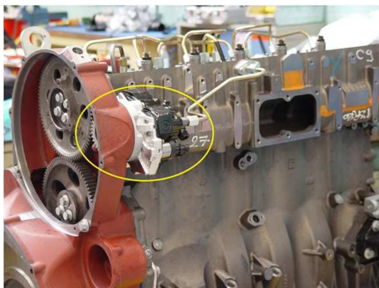
Obr.11 Vysokotlaké vstřikovací čerpadlo CP3 Bosch v motoru New Holland [7]
