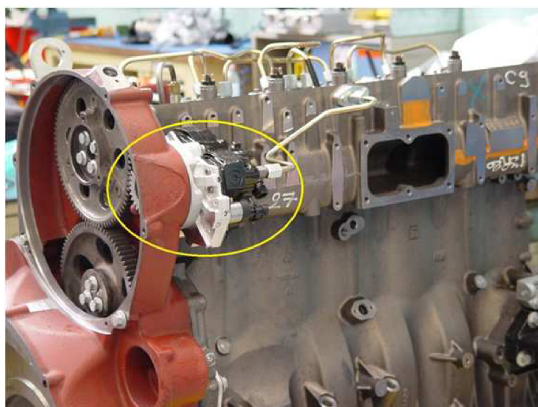
Obr.11 Vysokotlaké vstřikovací čerpadlo CP3 Bosch v motoru New Holland [7]
