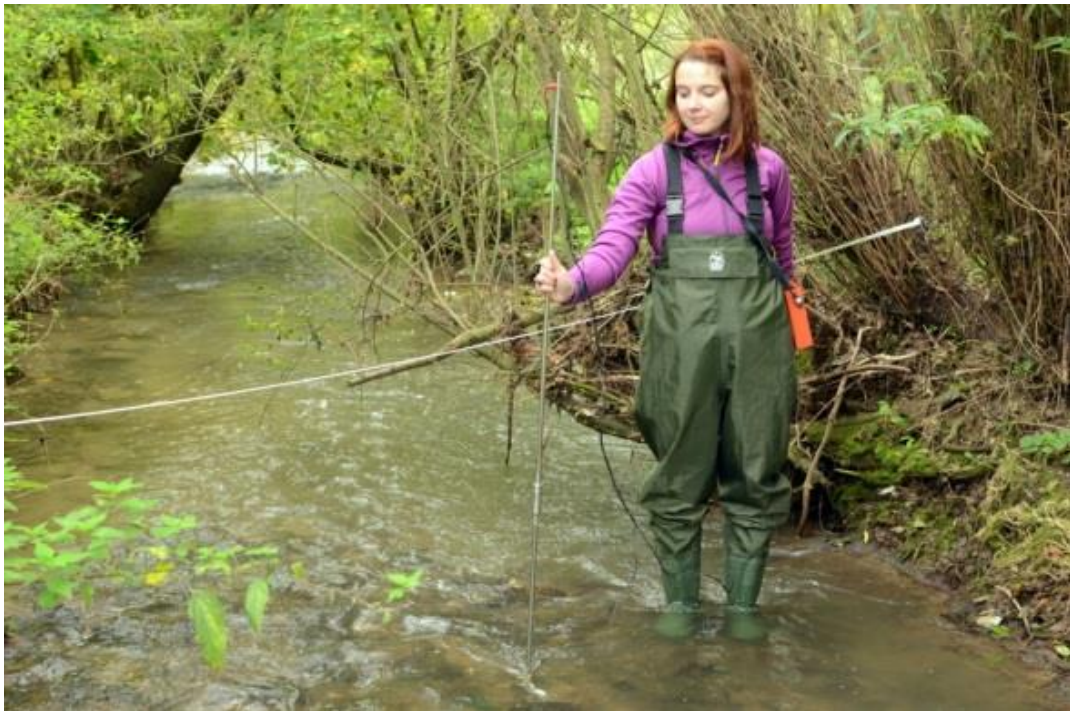
foto č. 22: Měření hydrometrickou vrtulí
