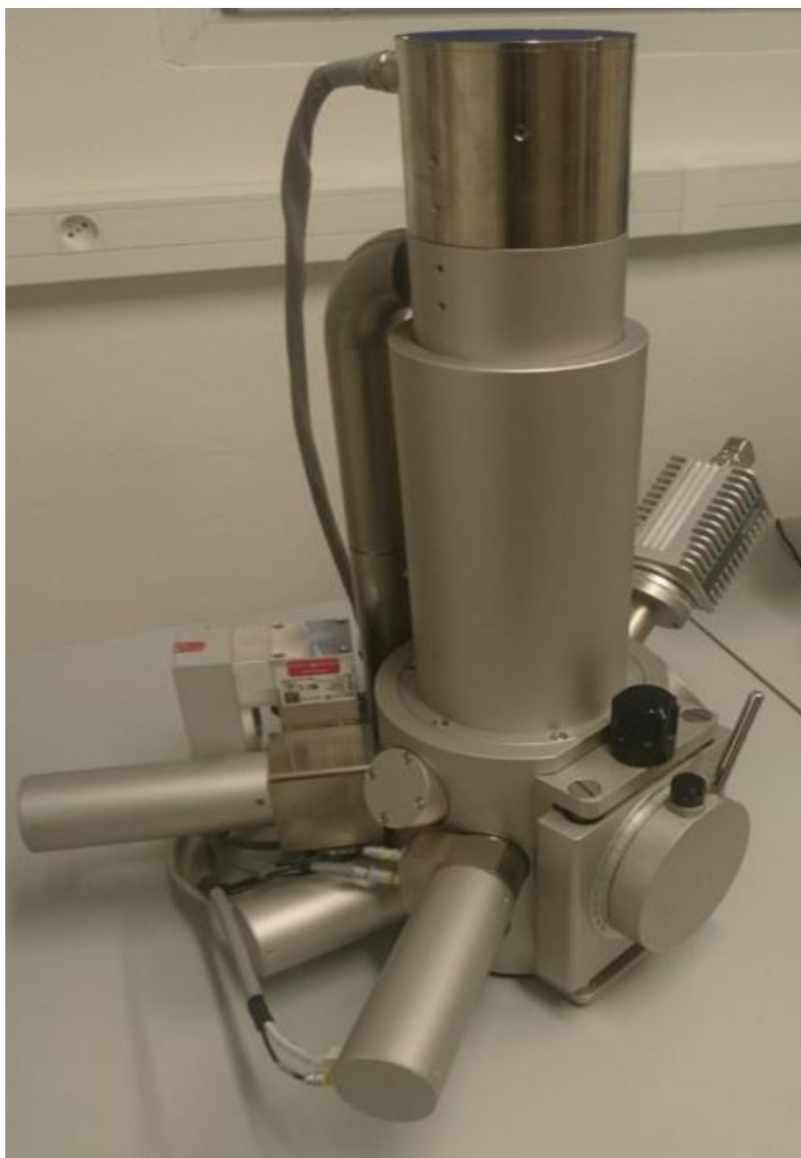
Obr. 29 Skenovací elektronový mikroskop Vega Tescan 3 SB Easy Probe.
