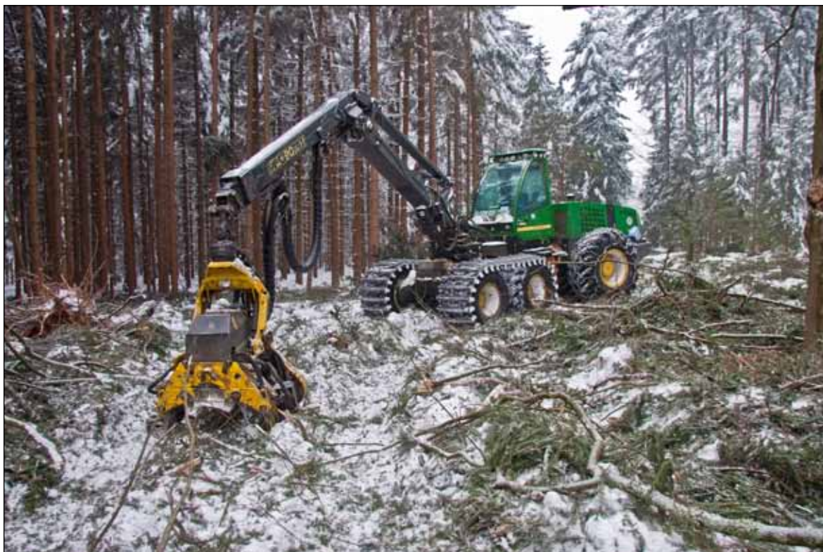
Harvestor John Deere 1470D se zimní výbavou při mýtní úmyslné těžbě
