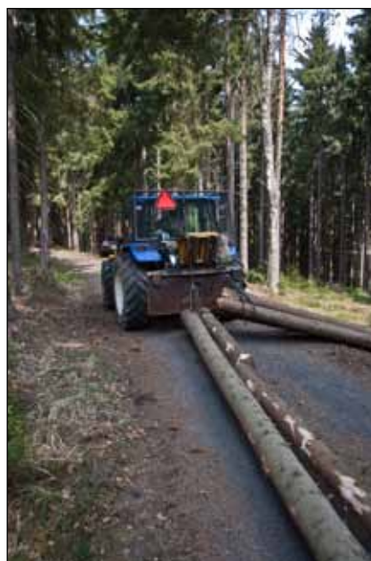
Mýtní úmyslná těžba komplexní četou s UKT – klasická kmenová metoda
