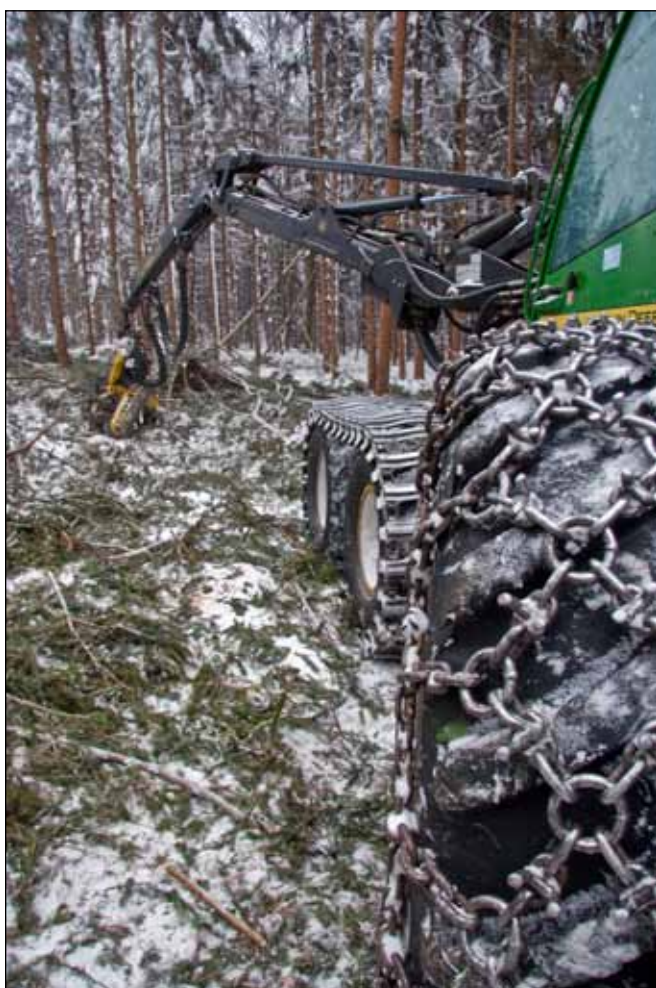
Harvestor John Deere 1470D se zimní výbavou při mýtní úmyslné těžbě
