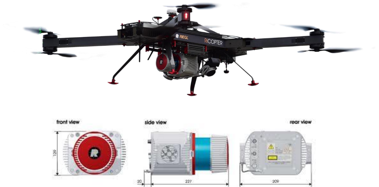
Obr. 7 – RIEGL RiCOPTER se senzorem VUX – 1UAV
