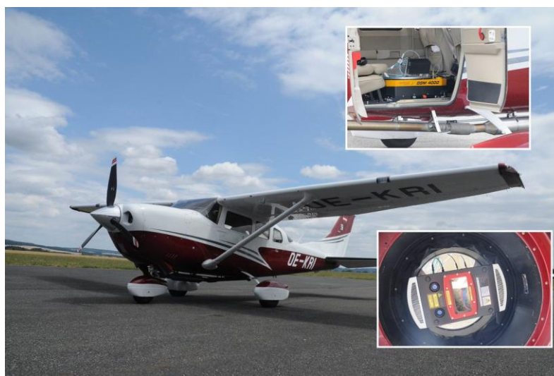
Obr. 3 – ALS – LiDAR senzor upevněný na letadle
