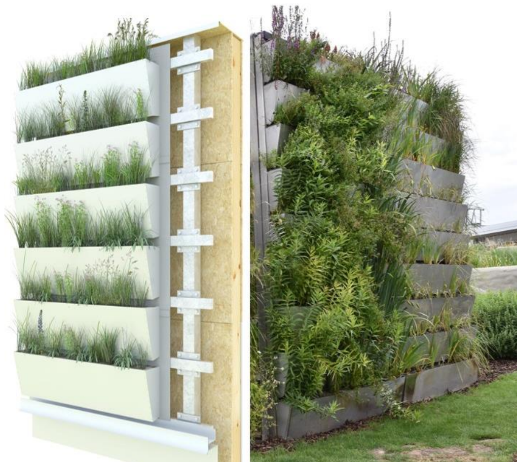
Obrázek č. 15 Schéma a realizace mokřadní fasády (Klímová 2022)
