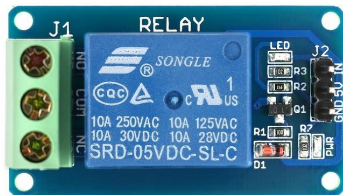
Obrázek 8: Relé modul pro arduino [45]
