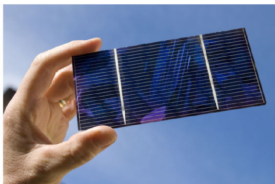
Obrázek 5. Křemíkový krystalický FV článek [16]
