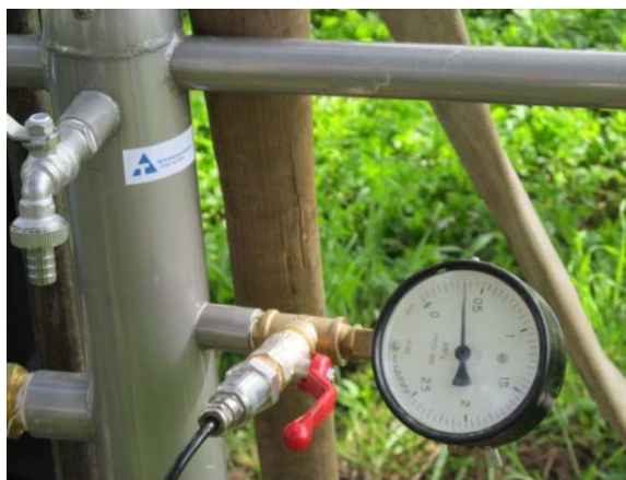
Obr. 4.3 Detail tlakových čidel
