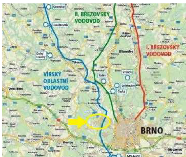
Obr. 3.2 Schéma zásobování vodou s vyznačenou lokalitou [19]
