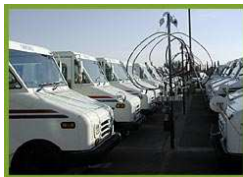
Obr. 12 Stanice pro plnění více vozidel
