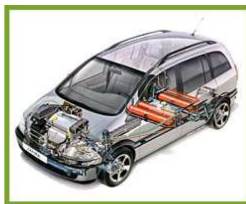
Obr. 19 Schéma uložení tlakových lahví
