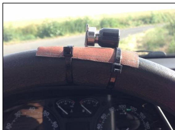
Obrázek 12, Uchycení akcelerometru, Zdroj: vlastní
