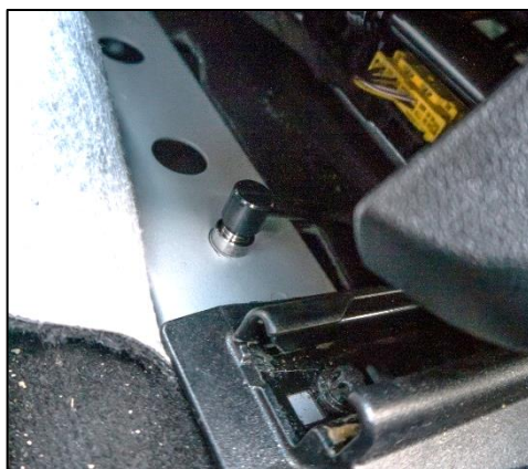
Obrázek 16, Uchycení akcelerometru na podlaze vozu W212, Zdroj: vlastní
