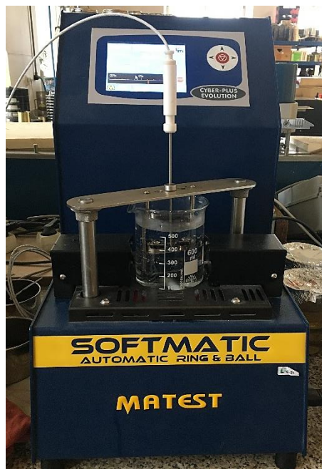
Obrázek 29 - Zkušební zařízení ke zkoušce bodu měknutí
