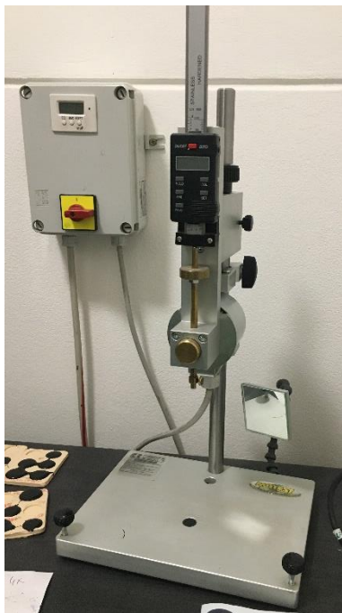
Obrázek 26 - Příklad ke stanovení penetrace jehlou
