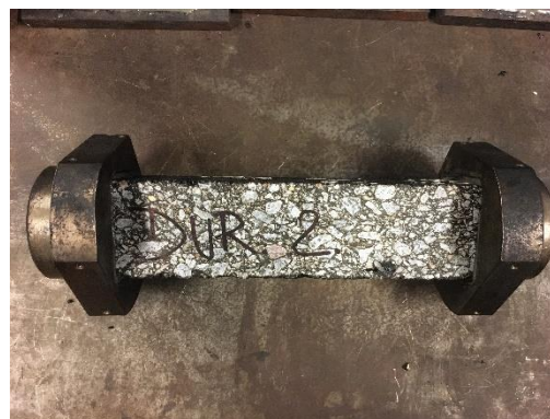
Obrázek 37 - Zkušební těleso připevněno v čelistech
