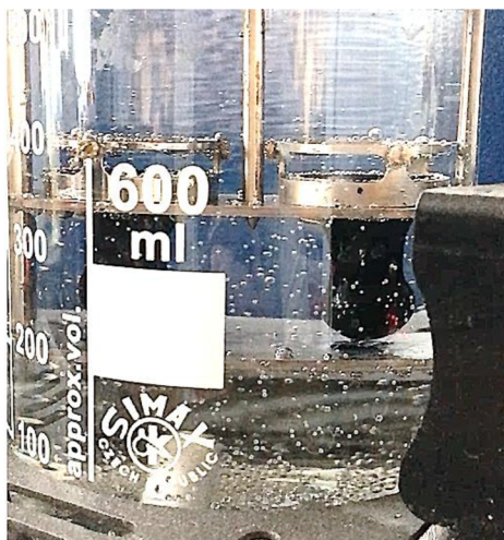
Obrázek 34 - Propad kuličky kroužkem
