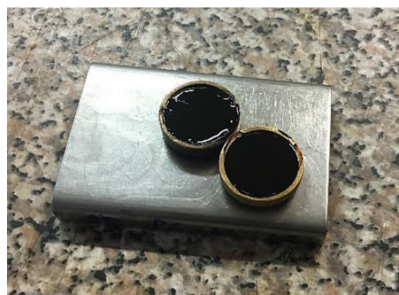
Obrázek 35 - Připravené kroužky s pojivem
