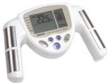
Obrázek 16. Osobní ruční tukoměr a dráha elektrického proudu v těle (upraveno dle http://www.inbody.cz/pristroje-bia.php )
