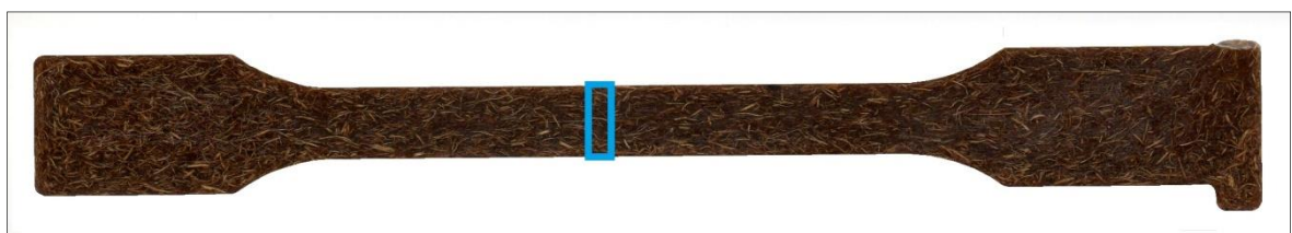
Obr. 3.12. Víceú elové zkuzební t lesa typu A s vyzna eným místem odb ru vzorku
