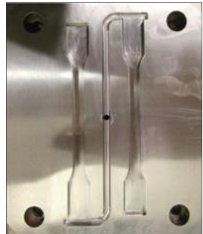
Obr. 3.7 Univerzální dvoudesková vstřikovací forma pro víceúhlová zkuzební tělesa typu A
