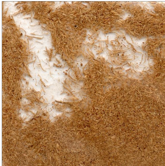
Obr. 3.5 Drcená plazmaticky upravená kokosová vlákna (1,5x zv. tzená)
