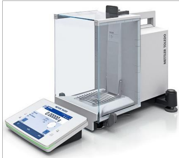
Obr. 3.13 Analytická váha Mettler Toledo XSE 105 Dual Range [51]
