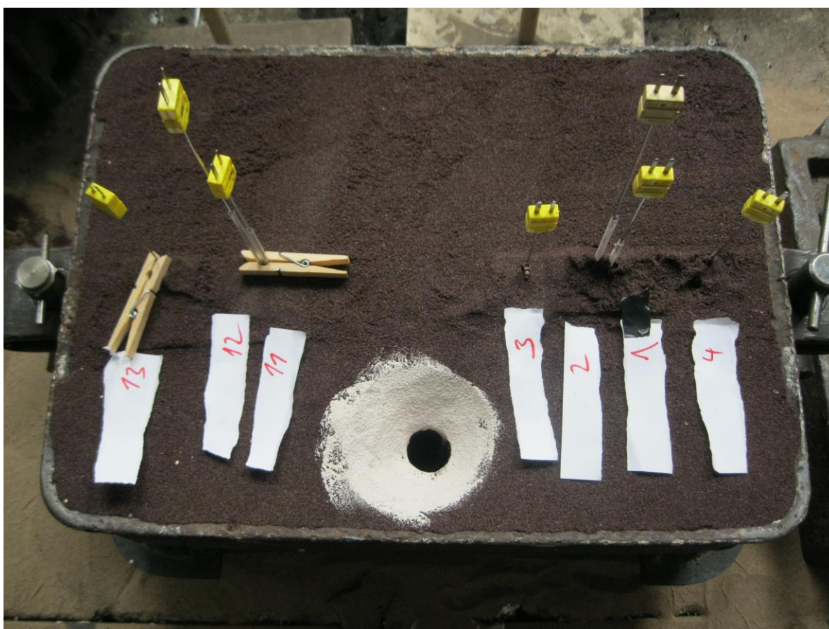
Obr. 0.2 Forma před litím s termočlánky
