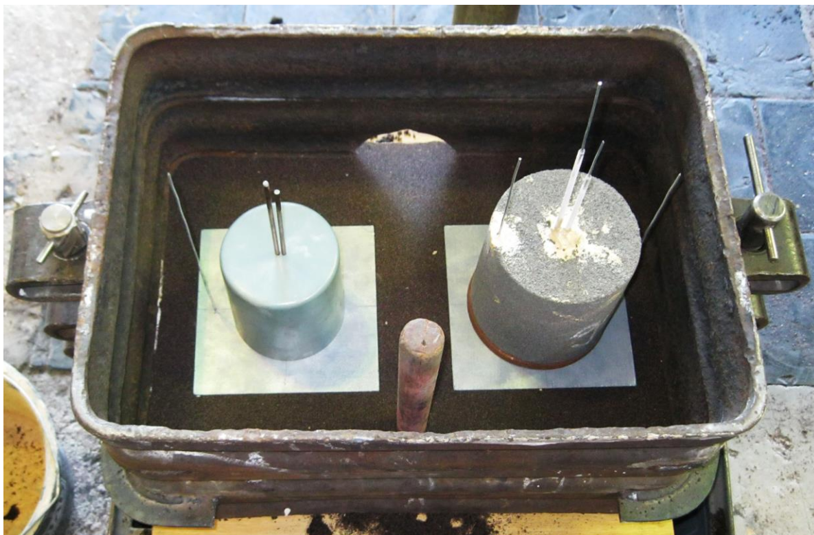
Obr. 0.1 Výroba vršku formy s přichystanými drátky a trubičkami pro budoucí umístění termočlánků
