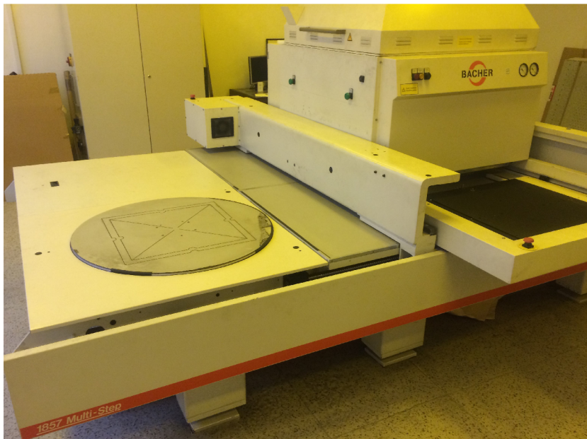
Obr. 5.2: Zařízení na výrobu ofsetových desek.
