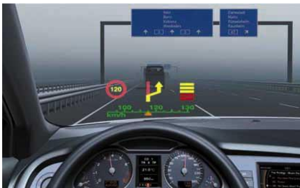
Obr. 13 Ukázka informací, které může Head-Up display zobrazovat [11]
