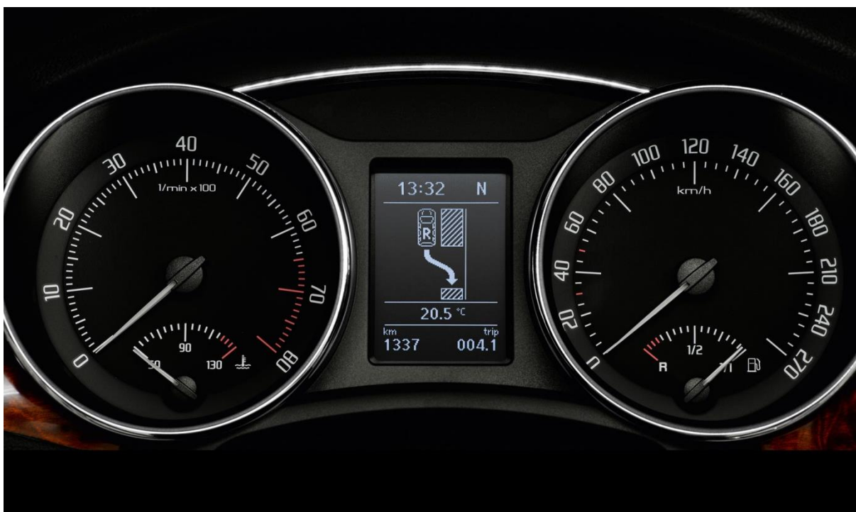
Obr. 10 Indikace volného parkovacího místa při podélném parkování [13]
