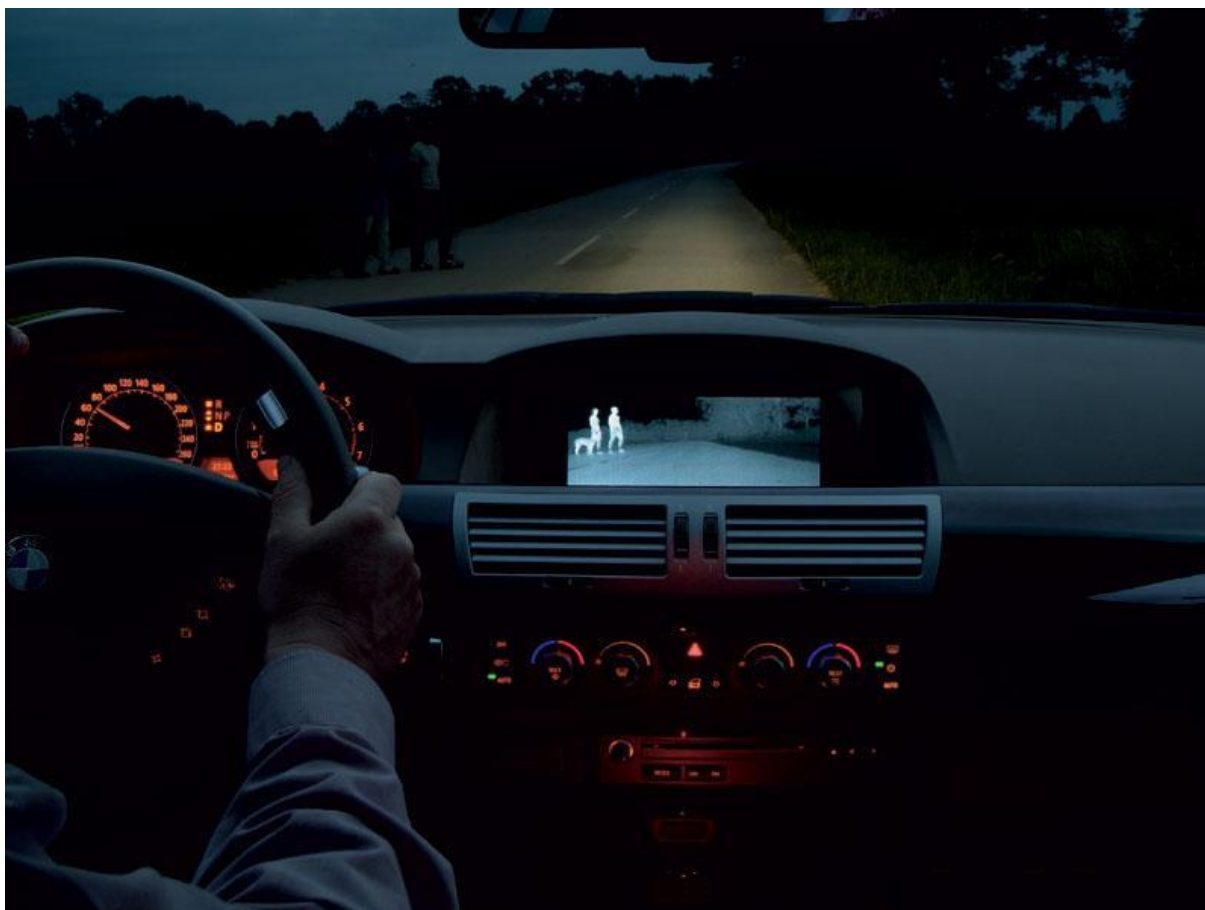
Obr. 2 Obraz z infračervené kamery v automobilu značky BMW [6]
