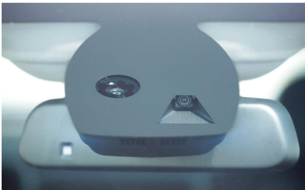
Obr. 3 Videokamera umístěná v modulu vnitřního zpětného zrcátka [8]
