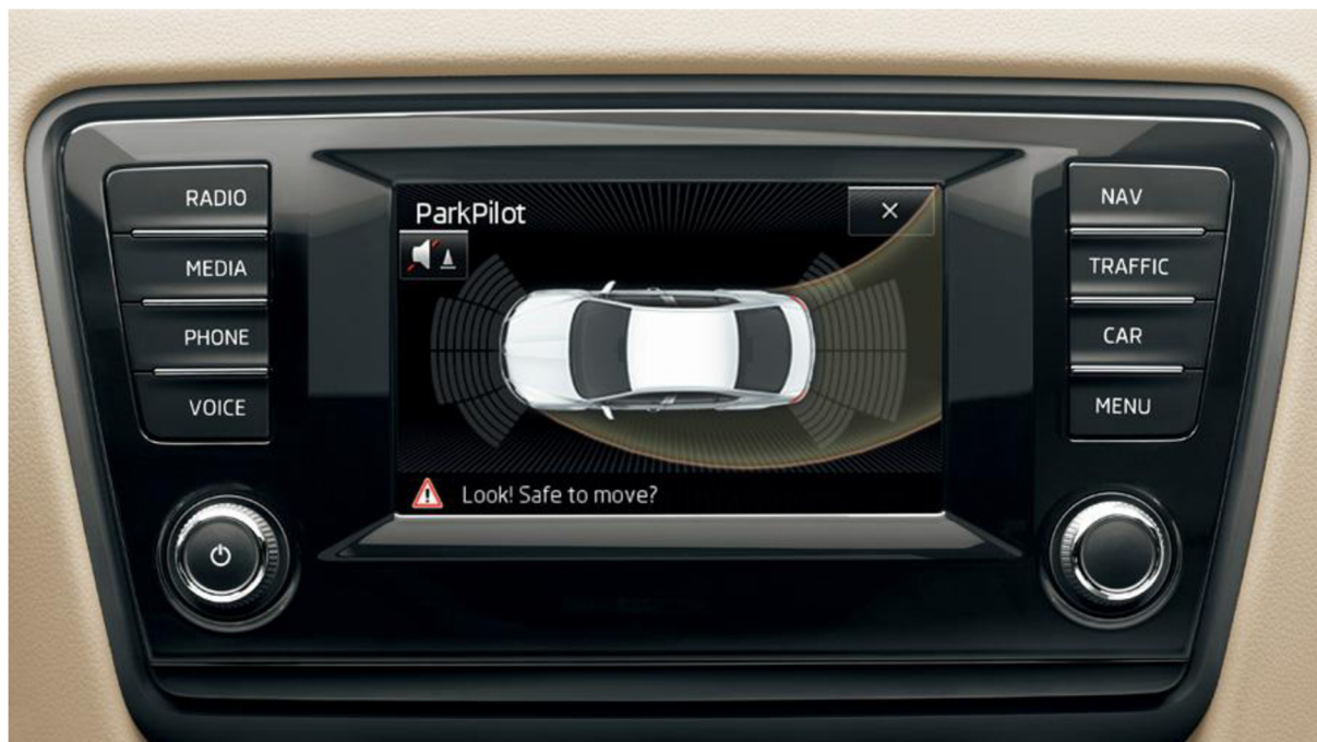
Obr. 9 Parkovací asistent v automobilu značky Škoda [14]
