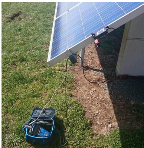
Obrázek 4 Měření intenzity slunečního záření kalibrovaným fotočlánkem v rovině panelu
