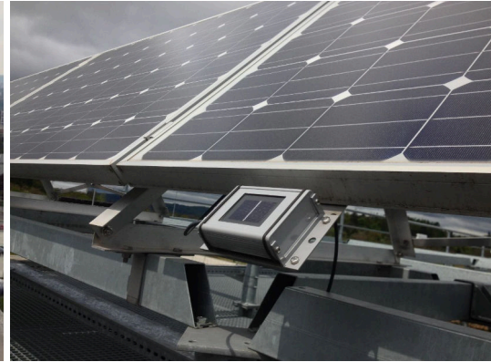
Obr. 2.7: Srovnávací fotovoltaický článěk typ SI01TCT [7]
