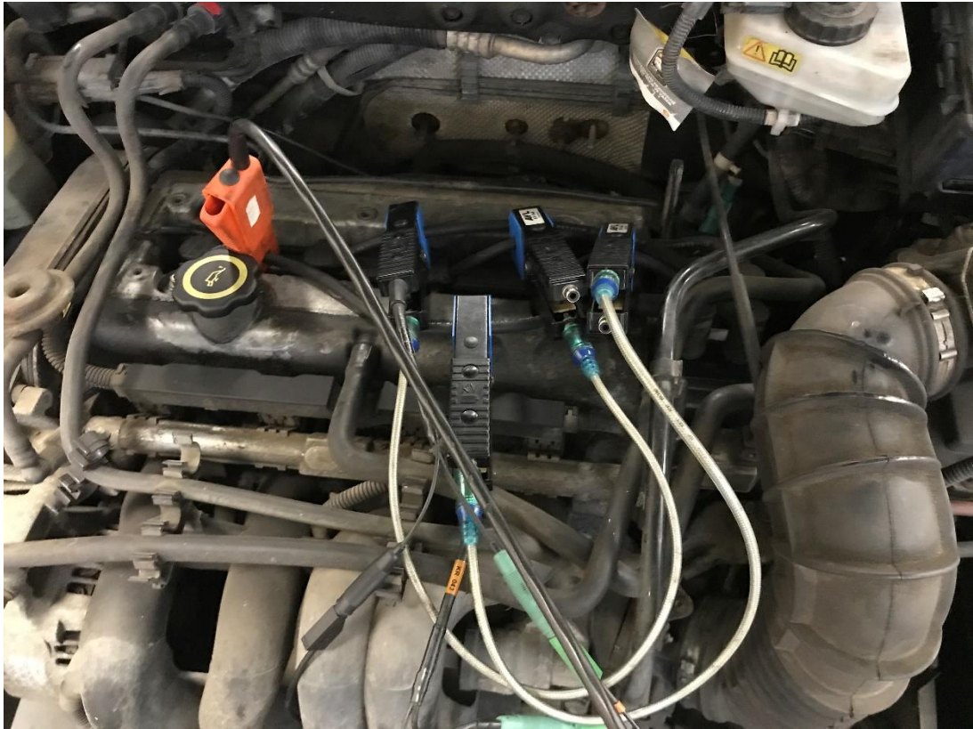
Obrázek 56 - připojení osciloskopu pomocí napěťových pick up kleští (oranžové) [4]
