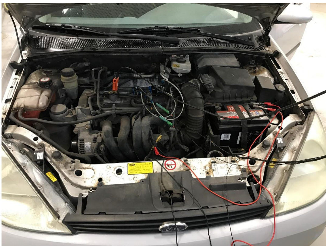
Obrázek 55 - celkový pohled na připojení měřicích kleští [4]
