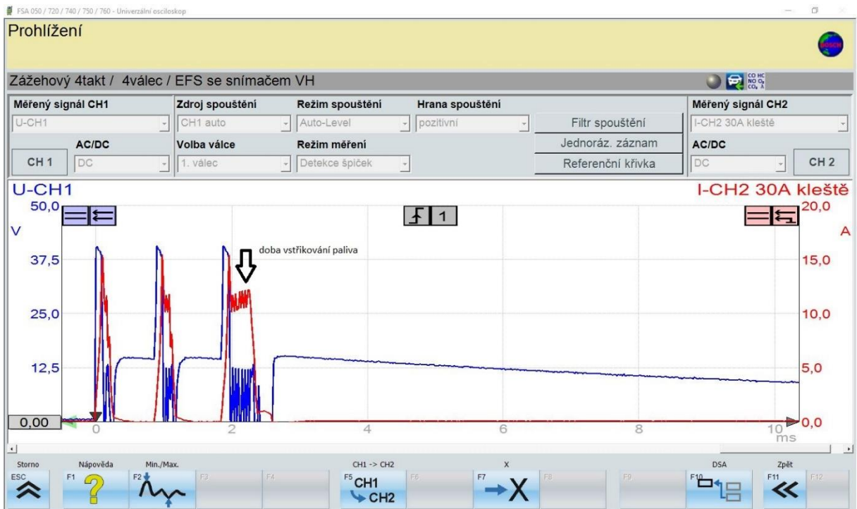
Obrázek 47 - signál napětí a proudu na cívkce vstřikovače [4]
