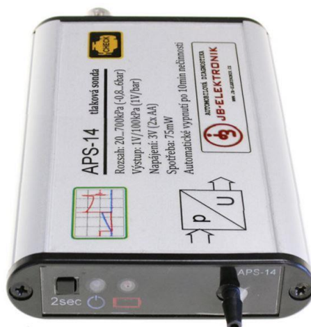
Obrázek 29 - tlaková sonda APS - 14 rozsah měření -0,8 - 6 bar [24]
