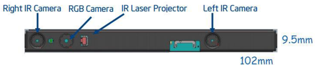
Obr. 5: Umístění komponent v kameře R200 [27]
