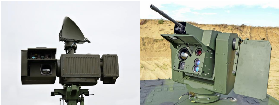
Obrázek 45: Sensorická hlava kompletu PzPK Sněžka a Zbraňová stanice vozidla LOV (autor Martin Smíšek)
