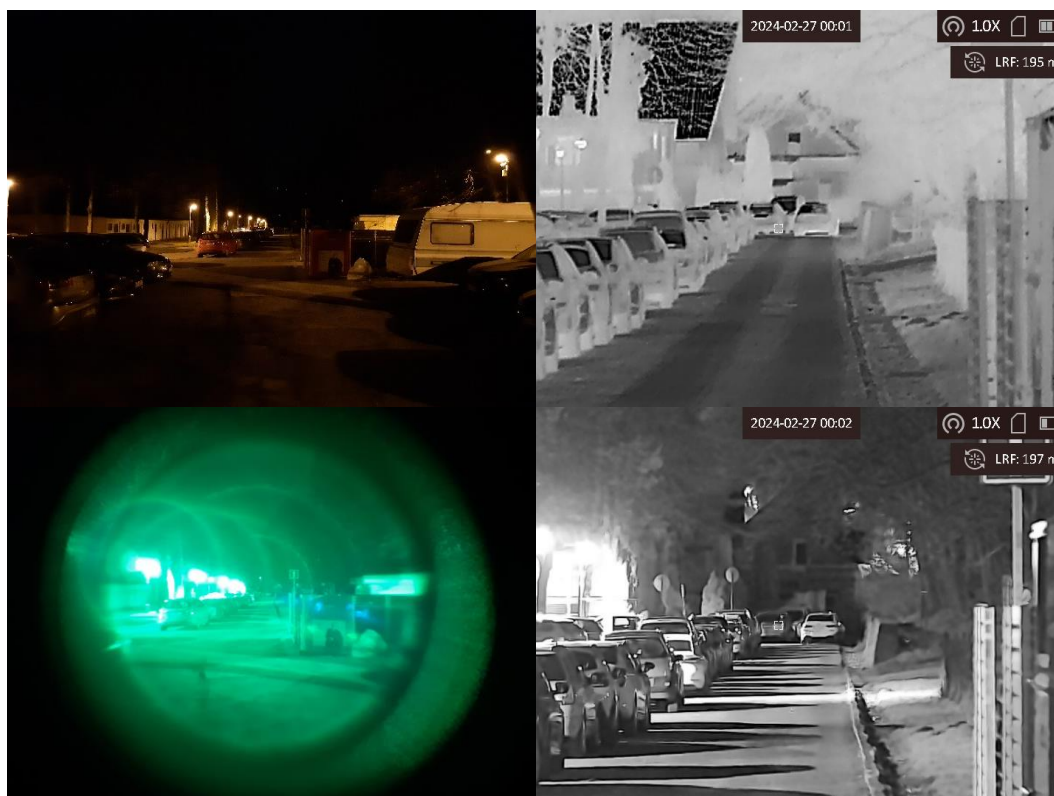
Obrázek 49: Porovnání přístrojů při pozorování v městské zástavbě, vzdálenost 200 m (vlastní foto)
