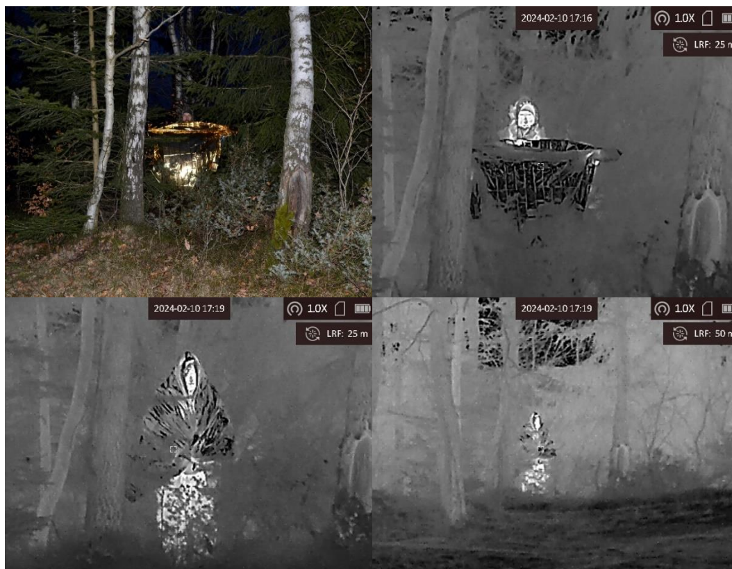
Obrázek 53: Vliv termofólie na detekci termovizí (vlastní foto)
