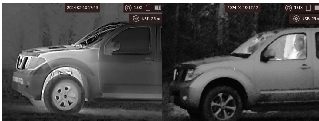
Obrázek 50: Porovnání termovize a noktovizoru při pozorování přes sklo (vlastní foto)
