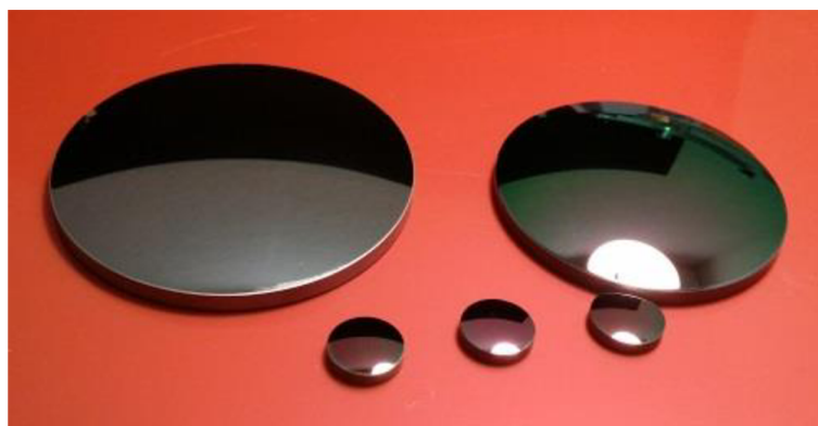
Obrázek 16: Čočky z germaniového skla (autor Alkor)
