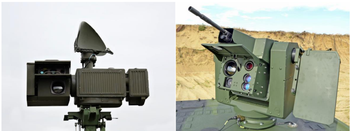
Obrázek 45: Sensorická hlava kompletu PzPK Sněžka a Zbraňová stanice vozidla LOV (autor Martin Smíšek)
