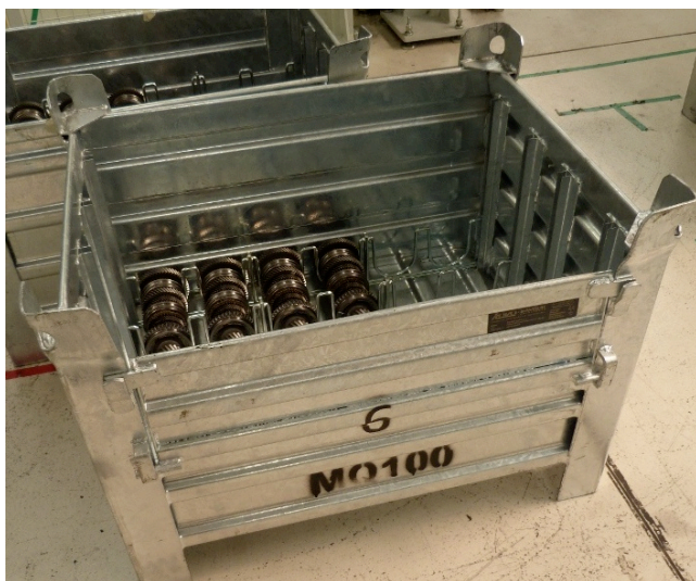
Obrázek č. 7: Paleta VP7101 s komplety hnaných hřídelů do převodovky (Vlastní)
