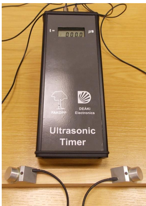
Obr. 25 a 26 Měřicí a zkoušecí přístroje Fakopp Ultrasonic Timer a trhací stroj TIRA 50 kN
