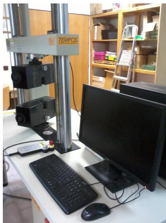
Obr. 25 a 26 Měřicí a zkoušecí přístroje Fakopp Ultrasonic Timer a trhací stroj TIRA 50 kN
