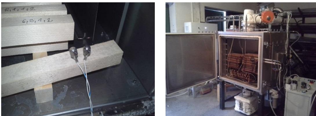
Obr. 24 Příprava vzorků v termokomoře – vlevo detail před úpravou, vpravo pohled na komoru po úpravě (autor Ing. Tomáš Holeček 2015)
