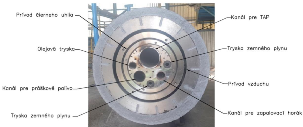
Obr. 4.1 - Hlavný horák rotačnej pece
