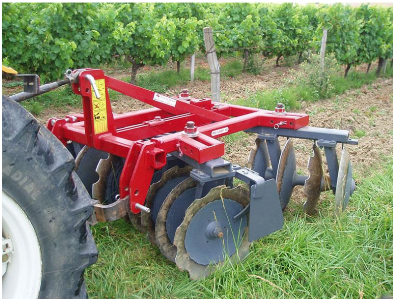
Obrázek 7: Talířový podmítač pro hloubkové kypření půdy (zdroj: www.hmhadonin.cz )
