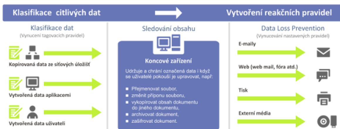
Obrázek 13 – Princip fungování DLP
