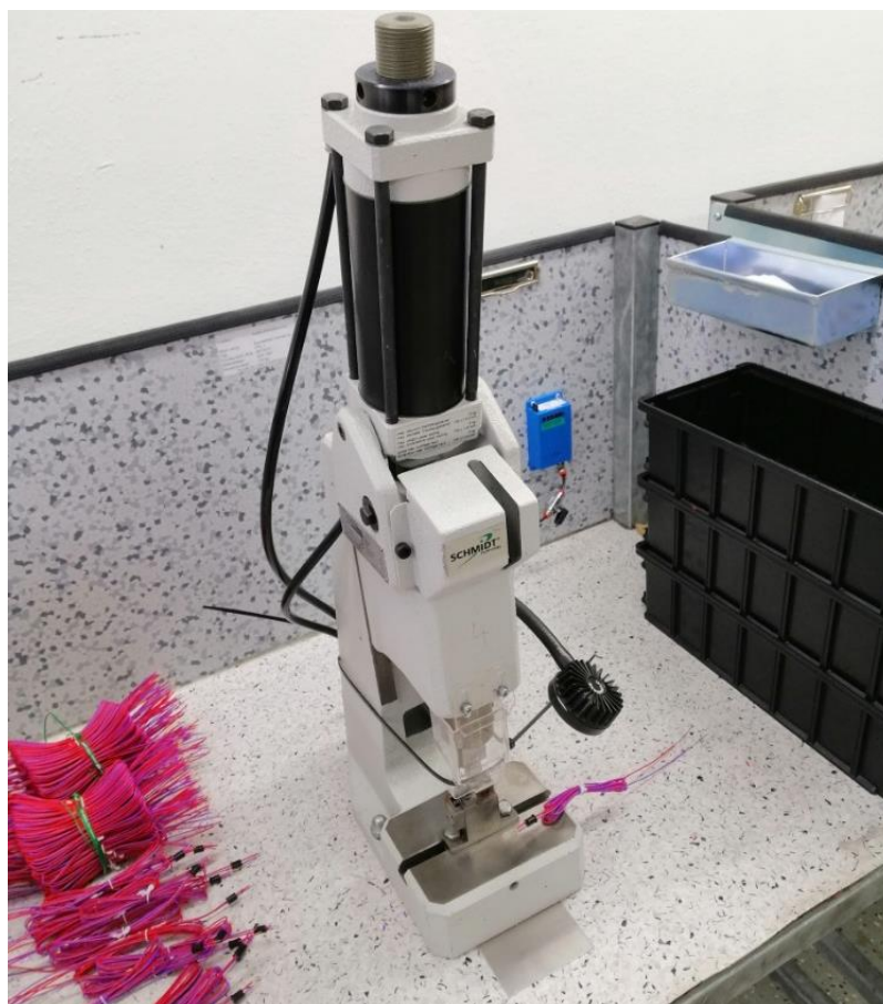
Obr. 2-9 Snímek přípravku používaného k úpravě konců vodičů
