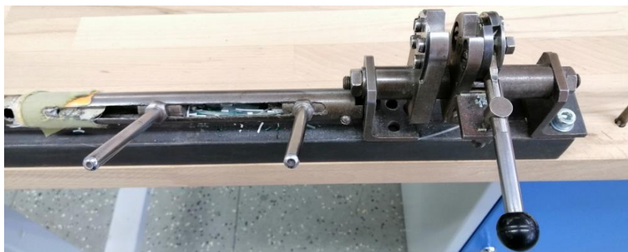
Obr. 2-14 Současný stav konstrukce přípravku pro namotání, zdrhnutí a zastřížení vodiče
