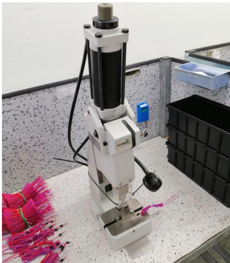
Obr. 2-9 Snímek přípravku používaného k úpravě konců vodičů
