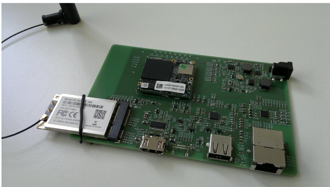
Obrázek E.2: Prototyp senzoru osazený CPU modulem i Wi-Fi.
