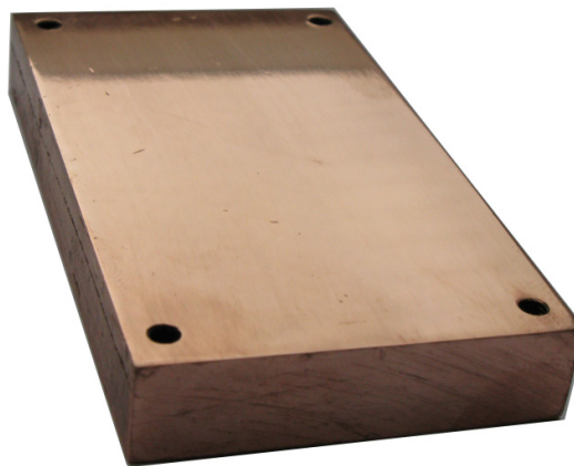
Obrázek 13 - Měděná destička o rozměrech 70x40x10 mm
