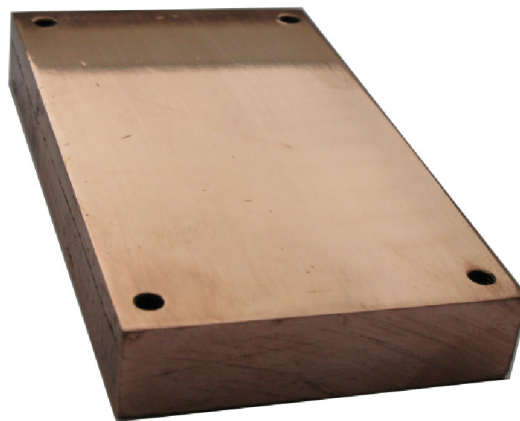
Obrázek 13 - Měděná destička o rozměrech 70x40x10 mm
