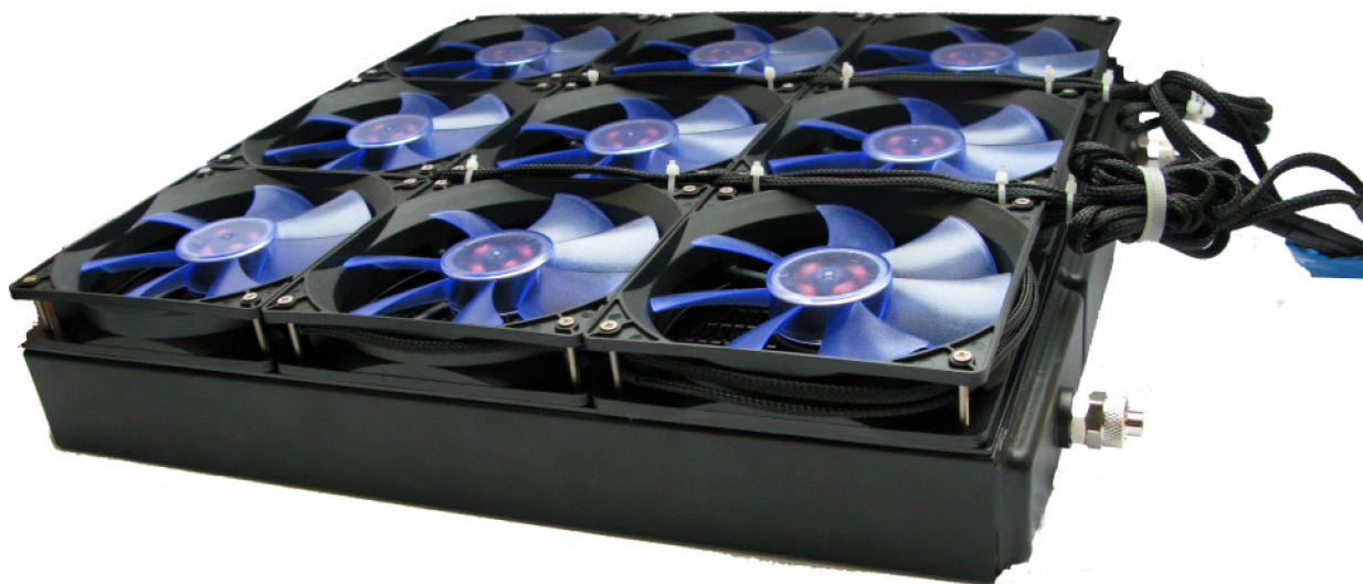
Obrázek 17 - Měděný chladič osazený 9 ventilátory
