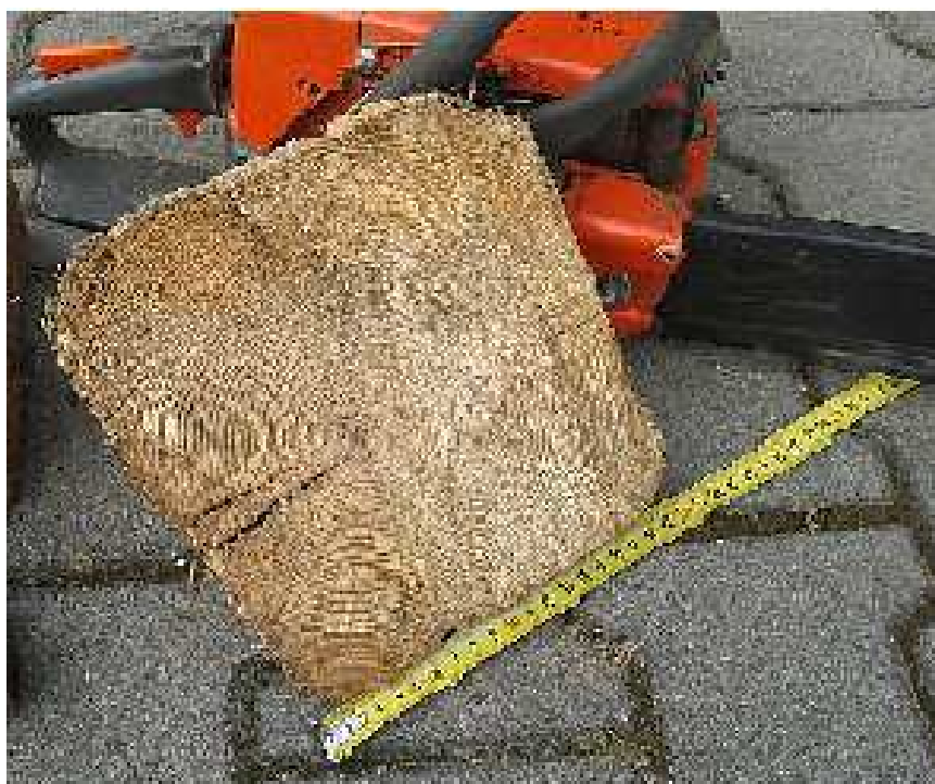
Obr. 14: Příčný řez – trámový výřez (Rataj 2014)
