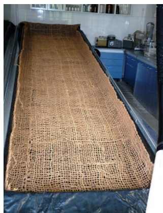
Obr. 4 Kokosová protierozní síť JUTENON ECC 700 umístěna do pokusného žlabu.
