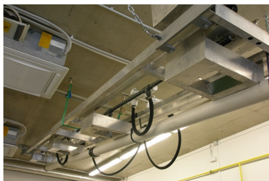
Obr. 1 Konstrukce dešťového simulátoru Norton v laboratoři Fakulty životního prostředí, České zemědělské univerzity v Praze.
