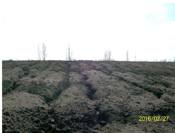
Obr. 5.3-2 Detail rýhové eroze na modelovém svahu v povodí jezera Medard
