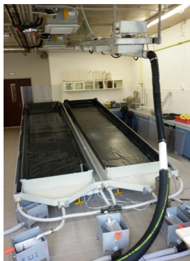
Obr. 2 Simulátor deště Norton nad pokusnými žlaby.
